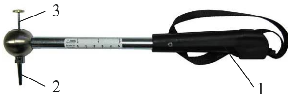
Рис. 2.40. Приростной молоток: 1 – ручка; 2 – наконечник; 3 – экстрактор
