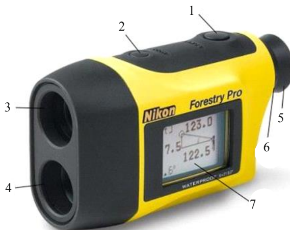
Рис. 2.36. Лазерный дальномер-высотомер Nikon Forestry 550 Pro: 1 – Power (питание); 2 – Mode (режим); 3 – линза монокулярного объектива/ отверстие лазерного излучателя; 4 – отверстие приемника излучения; 5 – наглазник/кольцо регулировки диоптрии; 6 – монокулярный окуляр (6-кратного увеличения); 7 – внешний ЖК-дисплей
