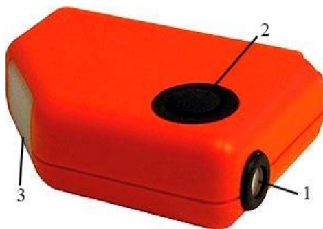
Рис. 2.32. Электронный высотомер-угломер Haglof Electronic Clinometer (HEC): 1 – окуляр; 2 – кнопка управления; 3 – окно
