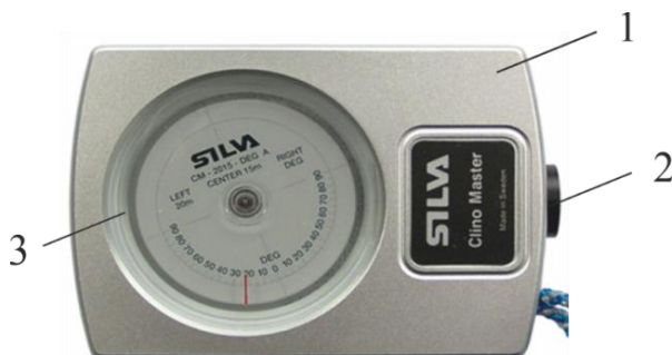
Рис. 2.27. Высотомер Silva Clino Master: 1 – корпус; 2– окуляр, 3– маятник со шкалами
