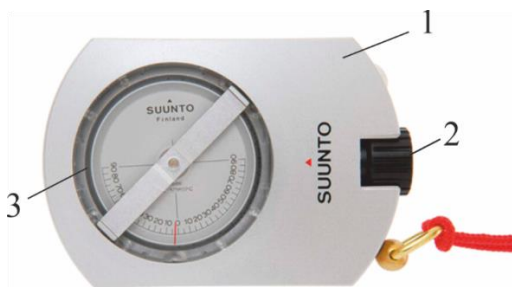
Рис. 2.24. Высотомер Suunto PM-1520: 1 – корпус; 2 – окуляр, 3 – маятник со шкалами
