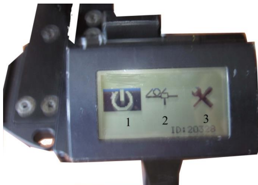
Рис. 2.12. Дисплей мерной вилки Masser BT Caliper с кнопками режимов: 1 – включение–выключение; 2 – измерения; 3 – настройки
