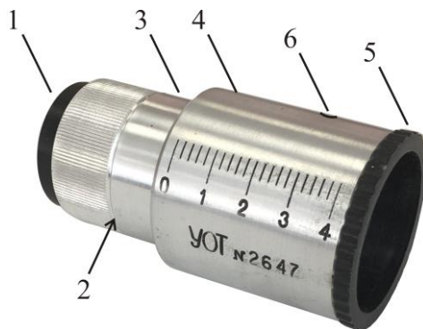
Рис. 2.41. Устройство оптическое таксационное: 1 – окуляр; 2 – линза; 3 – втулка, 4 – корпус, 5 – гайка; 6 – сквозное отверстие для керна
