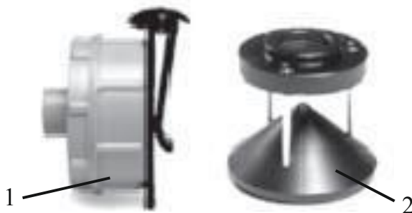
Рис. 2.34. Транспондер (1) и конусный отражатель (2), используемый с высотомером Vertex IV
